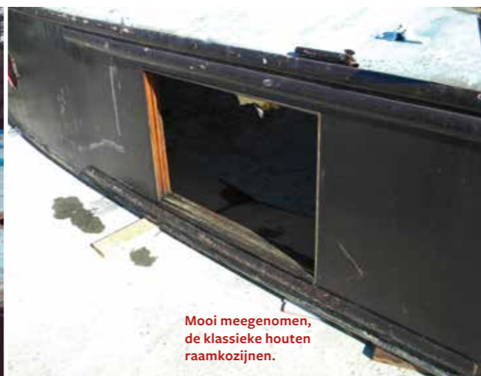
Aardig en netjes stuk laswerk, zeker op zo'n ingesloten plek. Die ronde railprofiel wordt niet meer gemaakt en Gerard heeft in dit geval moeten improviseren. Het geklonken randje onderaan is nog origineel.
